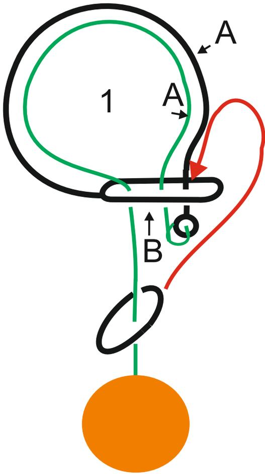
Partiendo de la figura 1 llevaremos la anilla, siguiendo la flecha roja y pasándola entre el tramo de alambre y el de cuerda marcados con una A y el otro tramo de alambre marcado con B, hasta rebasar con la parte inferior de la anilla la unión de la cuerda y el alambre. Subiremos la anilla, de manera que esta rodee el alambre y la cuerda siguiendo la flecha roja de la figura 2.
